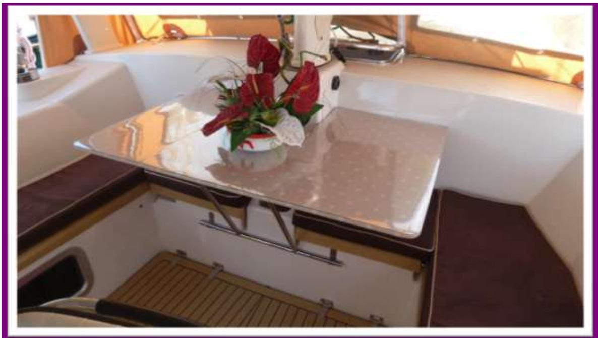
La table mesure 1.20 m x 0.80 m et est réalisée en contreplaqué marine de 10 mm avec protection époxy
