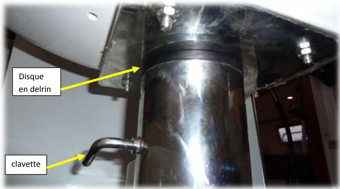
**Le fauteuil pivote sur un disque antifriction en delrin**
