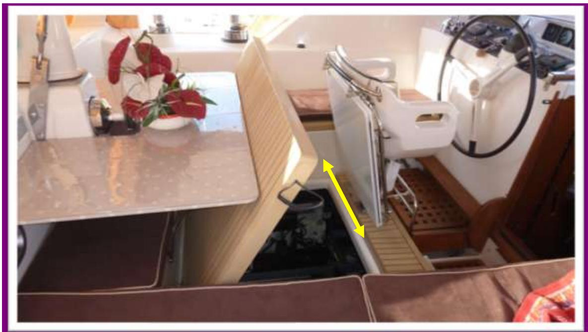
Le positionnement et l'inclinaison des pieds permet l'accès facile à la cale moteur
