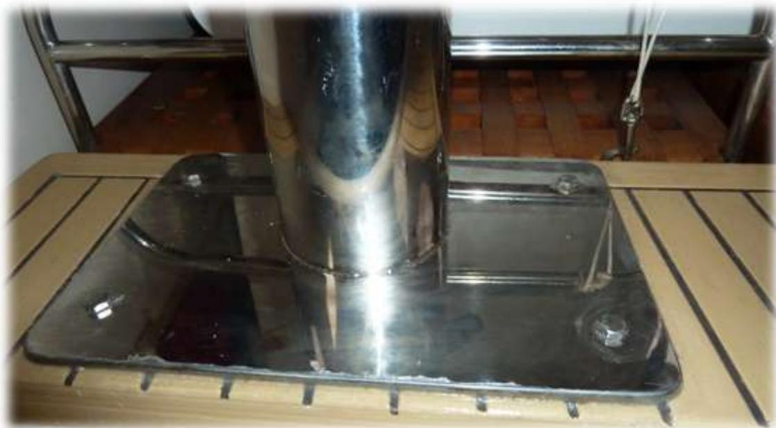
**le pied en inox est bien décalé vers l'avant à sa base et en retrait à sa partie supérieure**
