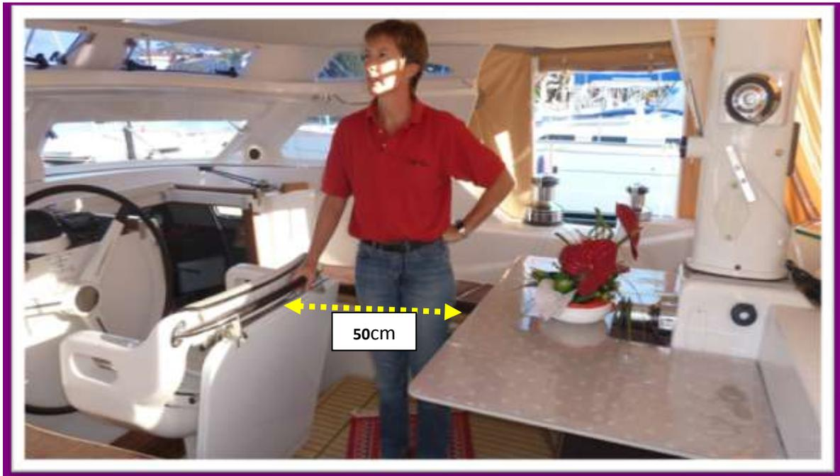
En navigation, la table est à sa place. L'espace de passage de 50 cm est suffisant pour effectuer les différentes manœuvres de cockpit, et l'accès aux winchs.
