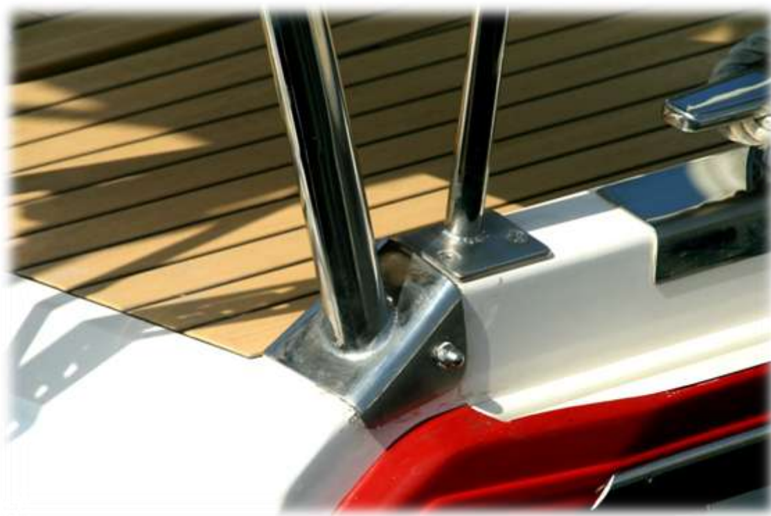
Fixations des pattes avant du portique, bien ajustées sur le bateau
