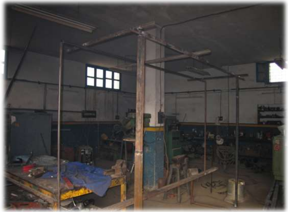
Nous transposons la configuration de l'arrière du bateau dans l'atelier
