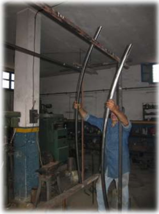
Les tubes inox cintrés sont prêts pour le montage, le puzzle s'assemble.
